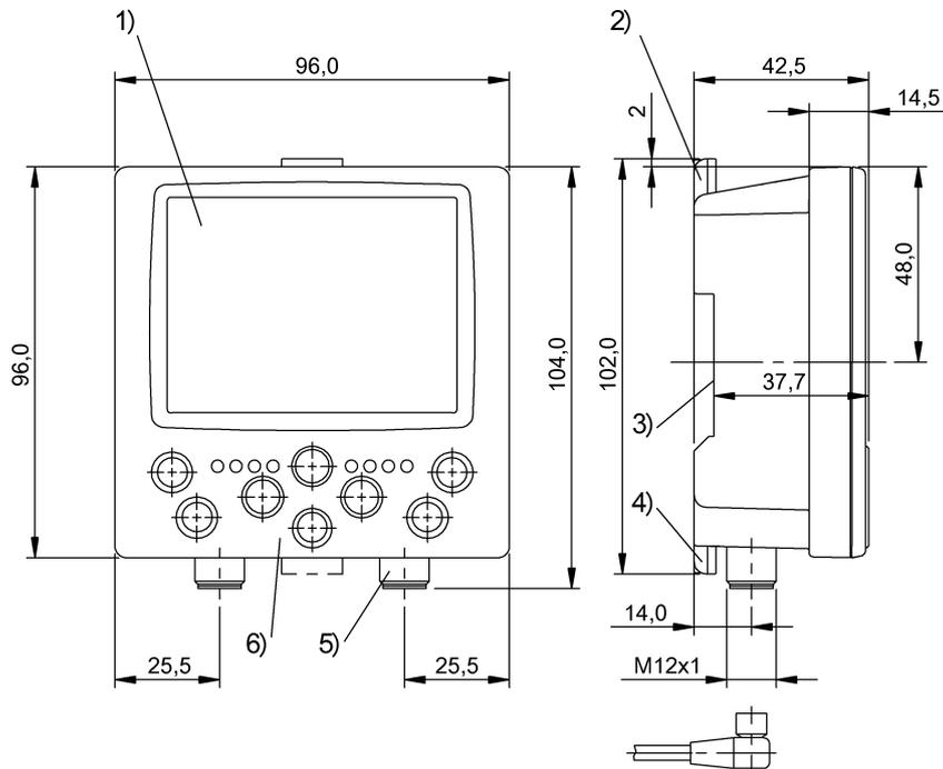
1) Цветной дисплей 3,5" 2) Фиксатор 3) для шины DIN 35 мм 4) Фиксатор 5) Разъем BVS/LAN 6) Панель индикации и управления
