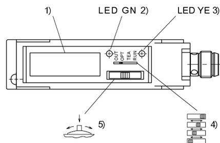
1) Дисплей 2) Стабильность 3) Функция выхода 4) Сдвижной переключатель, режим работы 5) Точковый выключатель
