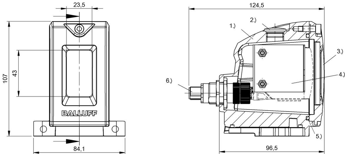
1) Корпус 2) Доступ к настройкам датчиков 3) Крышка 4) Крепежная пластина 5) Уплотнительное кольцо 6) Проход
