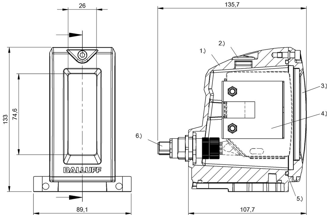
1) Корпус 2) Доступ к настройкам датчиков 3) Крышка 4) Крепежная пластина 5) Уплотнительное кольцо 6) Проход
