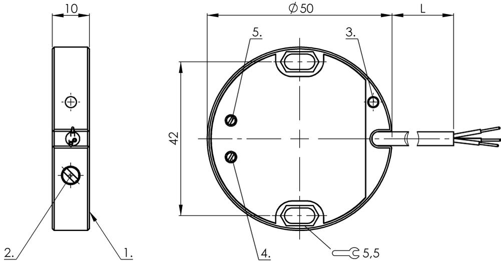
1) Активная поверхность 2) Потенциометр 3) Функциональный СИД 4) По выбору замыкатель или размыкатель 5) PNP или NPN на выбор
