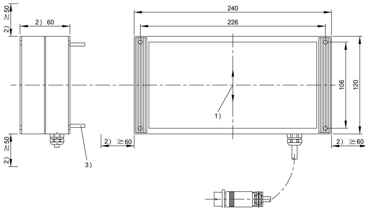
1) Активная поверхность 2) Свободная зона 3) 4x винта M4 DIN 912
