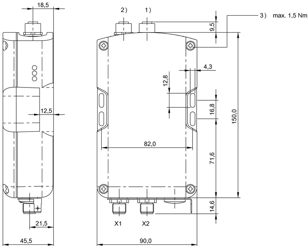
1) Головка 1 2) Головка 2 3) Момент затяжки
