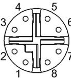
Bus In/Out (вход/выход шины) Конт. 1: D1+ Конт. 2: D1- Конт. 3: D2+ Конт. 4: D2- Конт. 5: D4+ Конт. 6: D4- Конт. 7: D3- Конт. 8: D3+
