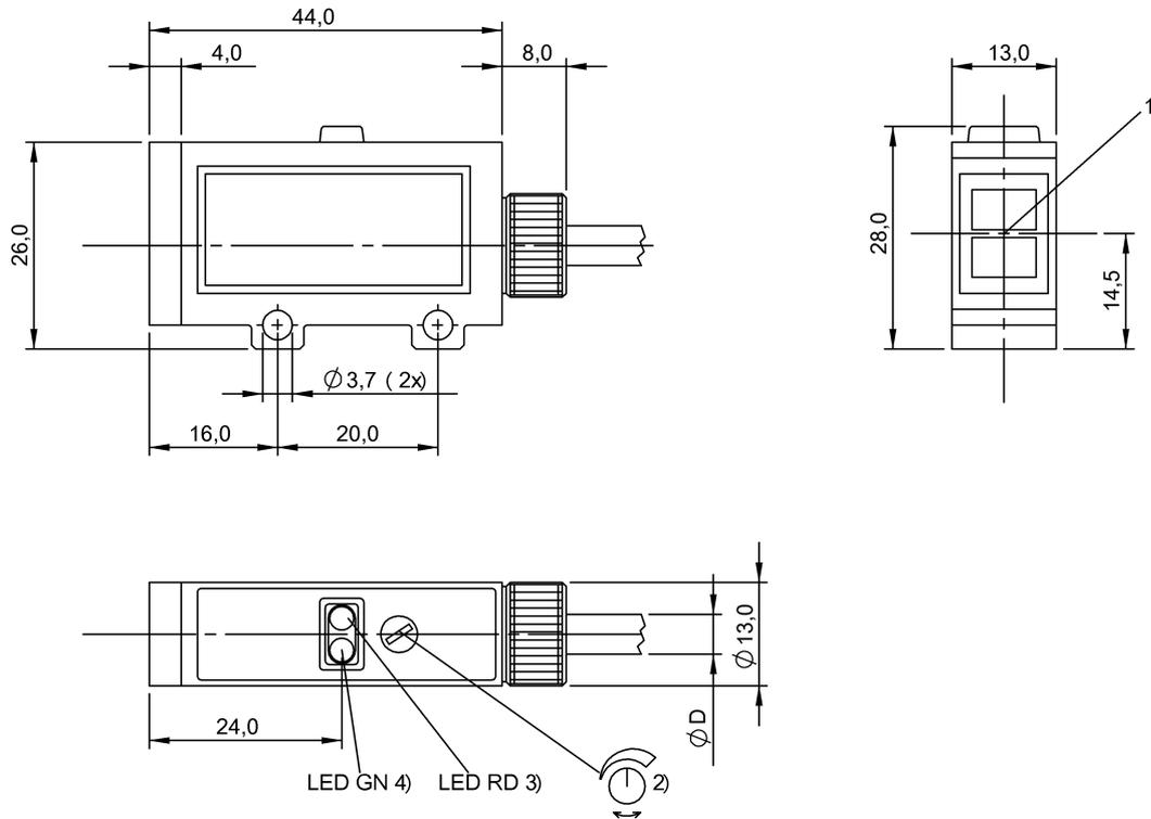
1) Оптическая ось 2) Sn 3) Функция выхода 4) Стабильность
