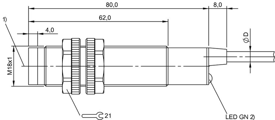
1) Оптическая ось 2) Напряжение питания
