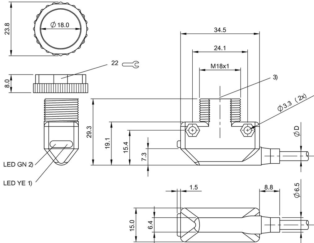
1) Функция выхода 2) Напряжение питания 3) Оптическая ось
