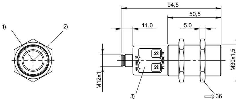
1) Ось ультразвукового преобразователя 2) Направление отхода 90° штекер 3) Панель индикации и управления
