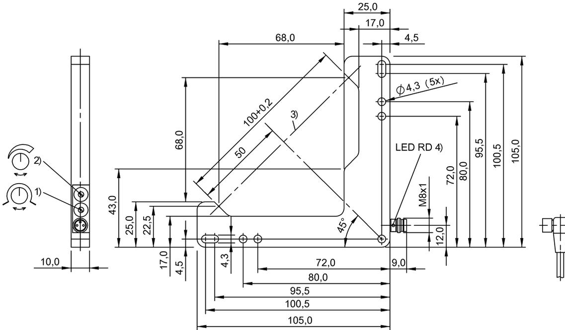
1) Включение при освещении / затемнении 2) Чувствительность 3) Оптическая ось 4) Функция выхода
