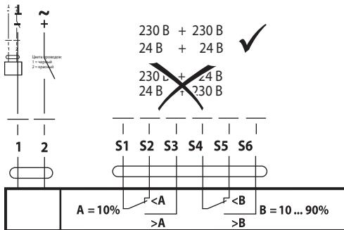
**Внимание! Соединять через изолированный трансформатор!**
