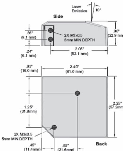
ID-01 Integral Right Angle Laser Scanner
