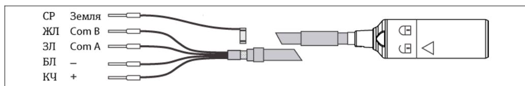
Вместо CP можно выполнить заземление через кабельный зажим преобразователя.
