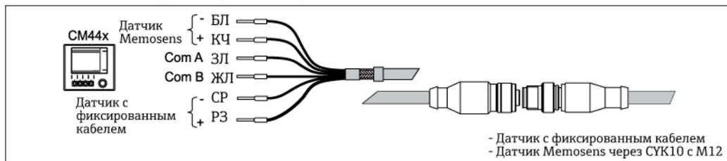
СУК11 с разъемом M12 и разъемом-розеткой M12
