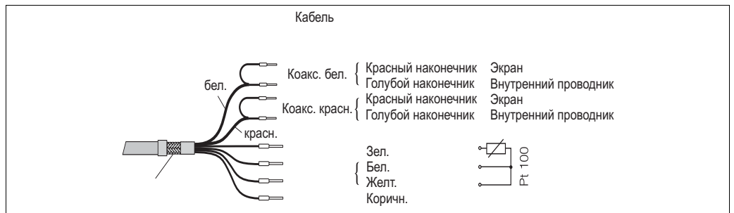
Встроенный кабель / специальный измерительный кабель CLK5
