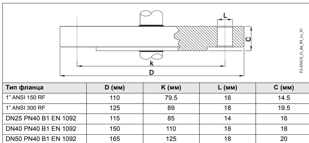
Рис. 9: Длины закрепления
