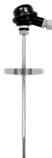
Датчики температуры TC 13 Omnigrad M - это термопары, специально спроектированные для высоко точной химической промышленности, а также для общих применений. Они состоят из измерительного зонда с защитной гильзой и корпуса, который может содержать преобразователь для преобразования измеряемых значений. Благодаря своему модульному дизайну и структуре ( стандарт DIN 43772 (форма 2F/3F), термопара TC 13 применима практически в любом промышленном процессе.
