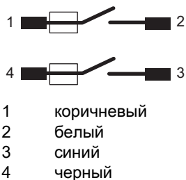
Рис. 7.6: Разводка жил, цвет жил кабеля подключения, состояние без включения с помощью управляющего элемента
