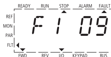
Figure 117: Exemple de signalisation de défaut (sous-tension)
