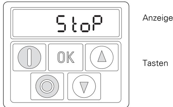
Abbildung 1: Ansicht der Bedieneinheit
