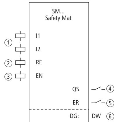
Abbildung 247: Funktionsbaustein „Schutzrüberwachung“
