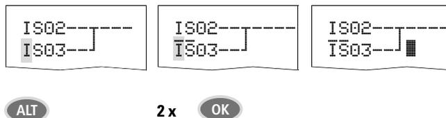
Abbildung 50: Kontakt I S03 von Schließer zu Öffner ändern
