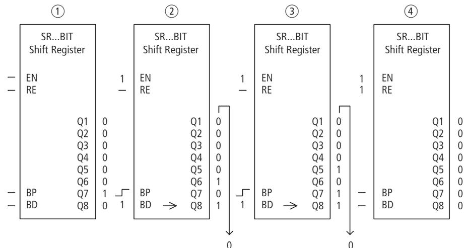
Abbildung 148: Schieberegister SR...: Rückwärtsoperation in der Betriebsart BIT
