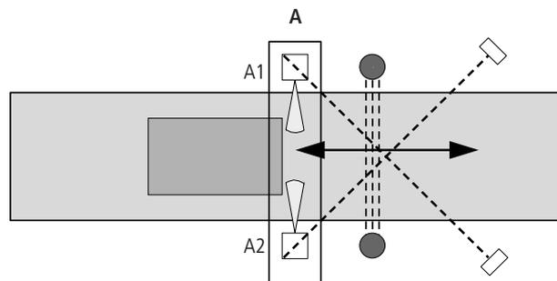
Abbildung 215:Lichtgitter Muting: Paralleles Muting mit 2 Mutingsensoren
