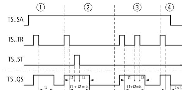
Abbildung 265:Wirkdiagramm „Zeitrelais rückfallverzögert“
