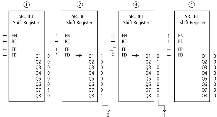
Abbildung 146: Schieberegister SR...: Vorwärtsoperation in der Betriebsart BIT
