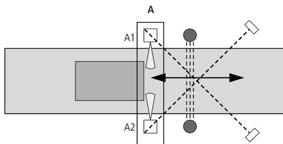
Abbildung 211: Lichtgitter Muting: Paralleles Muting mit 2 Mutingsensoren
