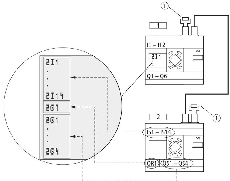
Abbildung 286: Ein- und Ausgänge eines easySafety ES4P-Gerätes im Standard-Schaltplan eines anderen Teilnehmers verwenden
