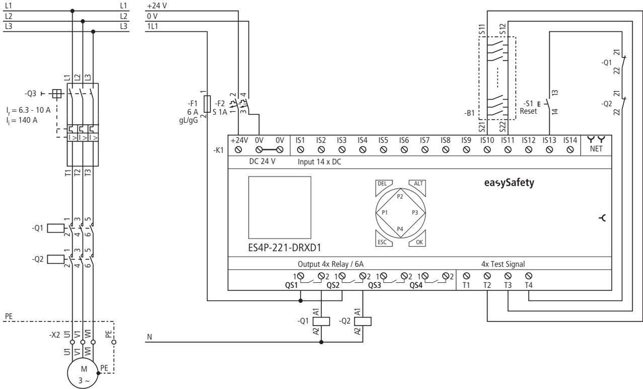
Abbildung 250: Beispiel „Schaltmatte“: Elektrischer Schaltplan
