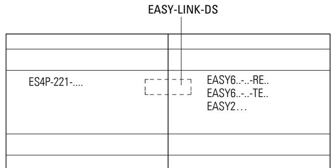
Abbildung 30: Lokale Erweiterungen mit easySafety ES4P verbinden
