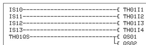
Abbildung 259: Beispiel 2 „Zweihandtaster“: Schaltplan in easySafety ES4P
