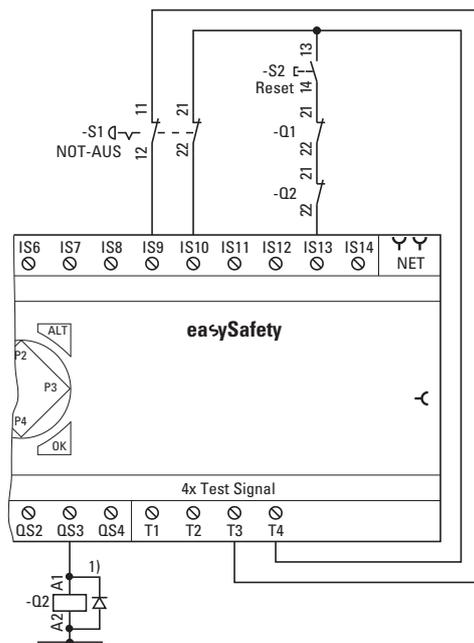
Abbildung 65: Verwendung von Testsignalen
