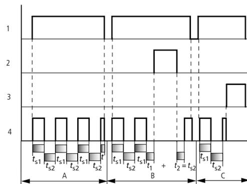
Abbildung 163: Wirkdiagramm „Zeitrelais“, blinkend synchron und asynchron
