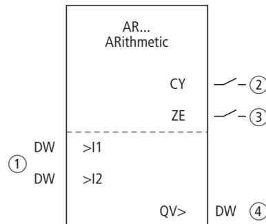
Abbildung 73: Funktionsbaustein „Arithmetik“
