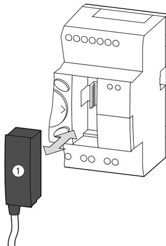
Abbildung 25: Programmierkabel ① an ein easySafety ES4P-Gerät stecken
