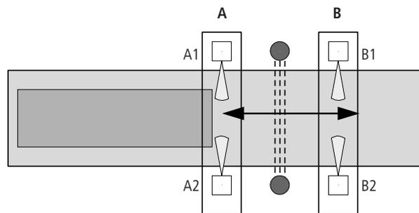
Abbildung 212:Lichtgitter Muting: Paralleles Muting mit 4 Mutingsensoren
