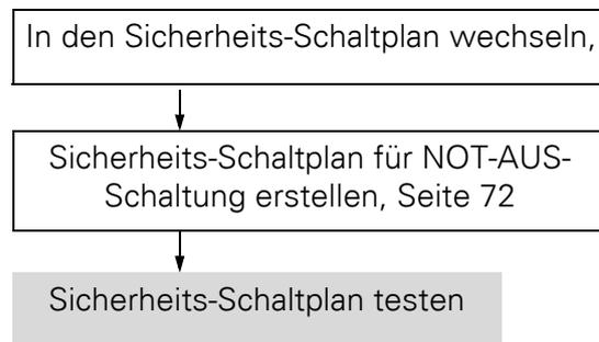
Wenn Sie den NOT-AUS-Taster und den Reset-Taster angeschlossen haben, können Sie den Schaltplan testen.
