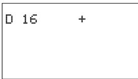
Wenn Sie den Baustein erstmalig im Schaltplan verwenden, gelangen Sie mit OK automatisch in die Gesamtanzeige der Bausteinparameter, wie beispielhaft in der Abbildung links dargestellt. Hier nehmen Sie die Bausteineinstellungen vor. Die Anzeige enthält folgende Elemente:
