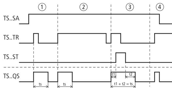
Abbildung 268: Wirkdiagramm „Zeitrelais, impulsformend“
