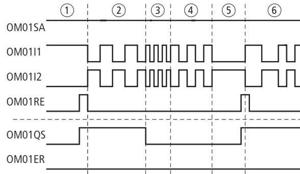
Abbildung 225: Beispiel „Höchstdrehzahlüberwachung“: Zeitdiagramm
