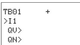
Wenn Sie den Baustein erstmalig im Standard-Schaltplan verwenden, gelangen Sie mit OK automatisch in die Gesamtanzeige der Bausteinparameter, wie beispielhaft in der Abbildung links dargestellt. Hier nehmen Sie die Bausteineinstellungen vor, in diesem Fall das Zuordnen der Ein- und Ausgänge zu den Operanden. Die Anzeige enthält folgende Elemente:
