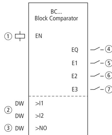
Abbildung 75: Funktionsbaustein „Datenblock-Vergleicher“
