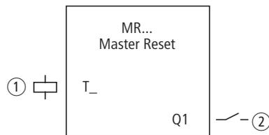
Abbildung 123: Funktionsbaustein „Masterreset“
