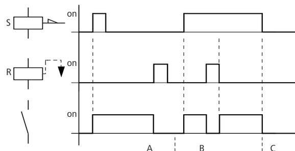
Abbildung 60: Wirkdiagramm „Setzen“ und „Rücksetzen“
