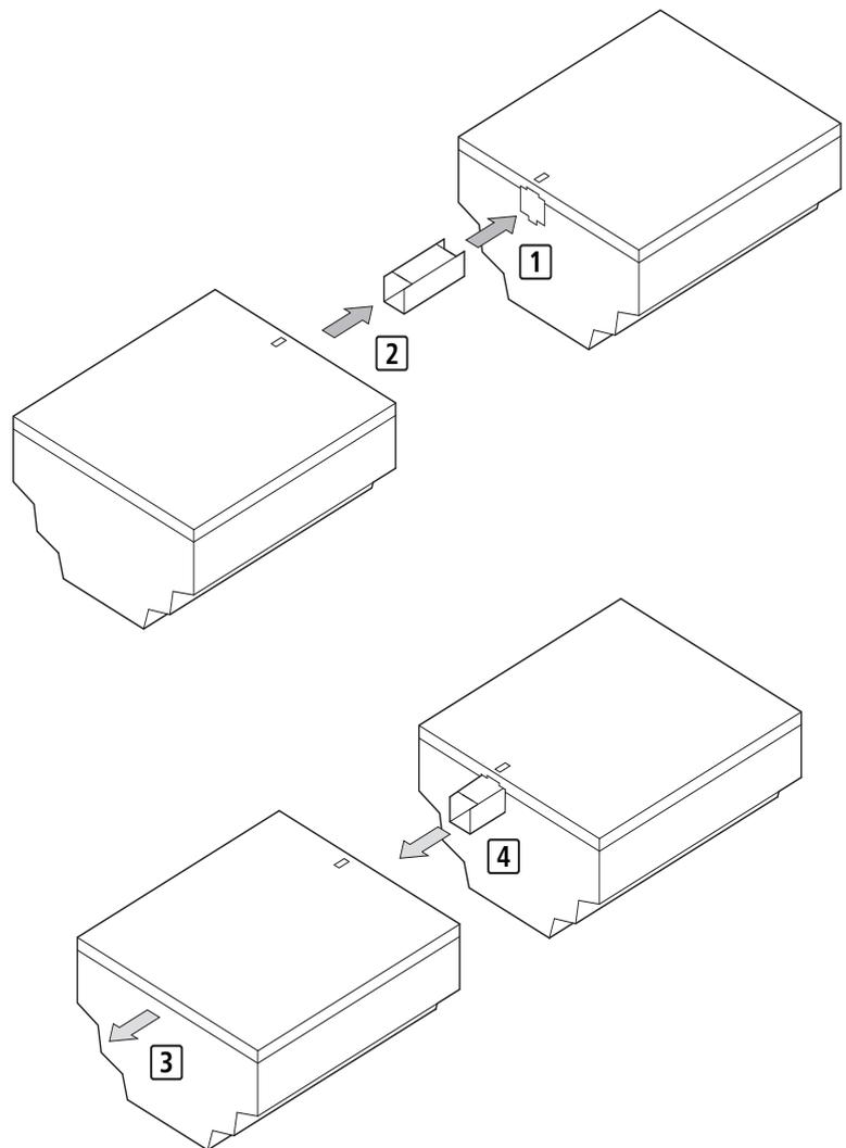
Abbildung 7: Erweiterungen montieren 1 + 2 und demontieren 3 + 4
