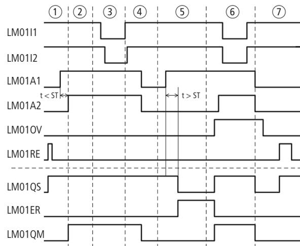
Abbildung 218: Beispiel „Lichtgitter Muting“: Zeitdiagramm ungestörter Betrieb
