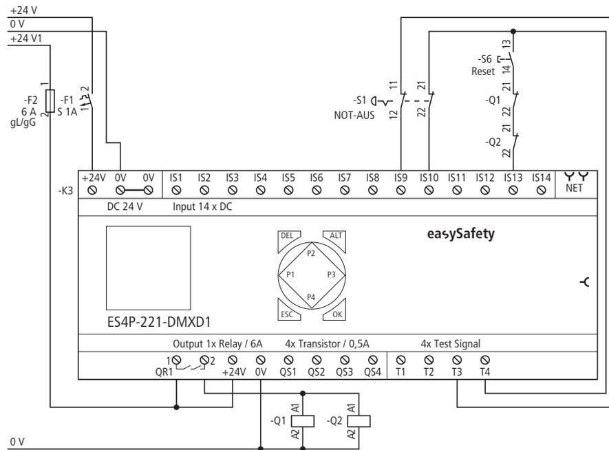
Abbildung 11: Beispiel-Anwendung NOT-AUS, zweikanalig mit Basisgerät easySafety ES4P
