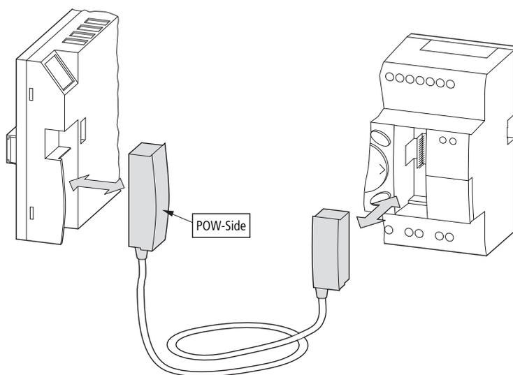
Abbildung 27: Verbindungsstecker stecken: links MFD-CP..., rechts easySafety ES4P
