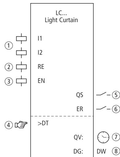
Abbildung 198:Funktionsbaustein „Lichtgitter“
