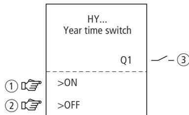
Abbildung 109:Funktionsbaustein „Jahresschaltuhren“
