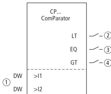
Abbildung 87: Funktionsbaustein „Vergleicher“
