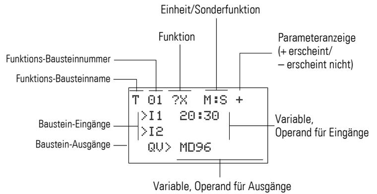
Abbildung 68: Anzeige der Standard-Funktionsbausteine im Bausteineditor
