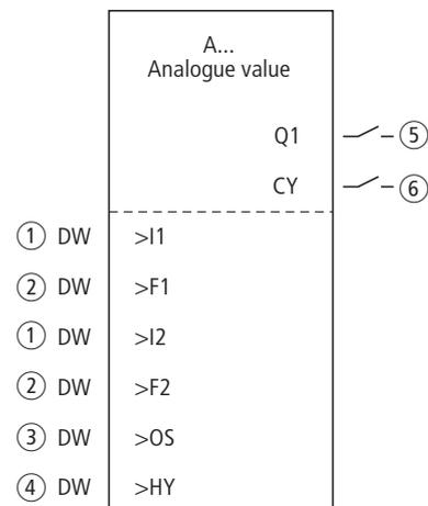
Abbildung 70: Funktionsbaustein „Analogwert-Vergleicher“
