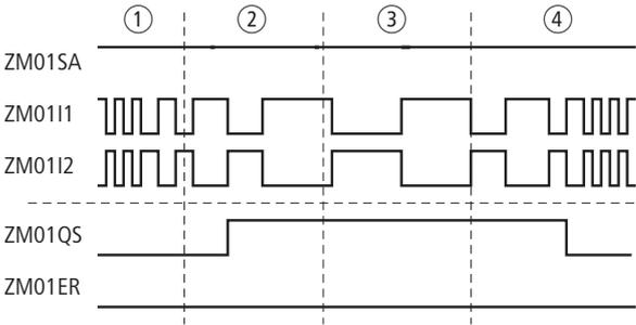
Abbildung 278:Beispiel „Stillstandsüberwachung“: Zeitdiagramm
