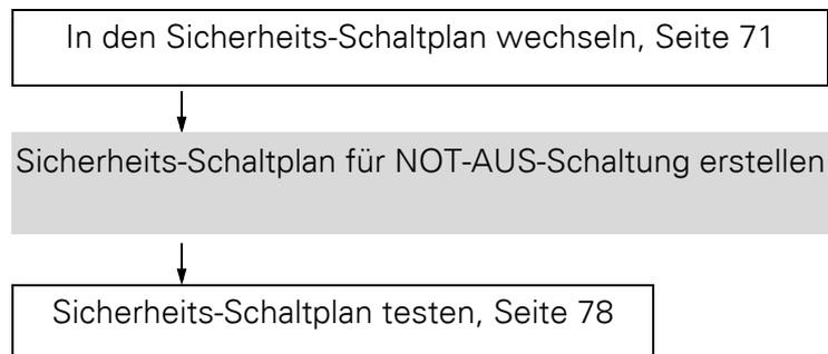
Das **easySafety** ES4P-Gerät soll mittels des Sicherheits-Funktionsbausteines ES.. (Emergency Stop = NOT-AUS, → Seite 278) die Aktivierung eines NOT-AUS-Tasters erfassen und über ein Lastschütz die Maschine ausschalten.
