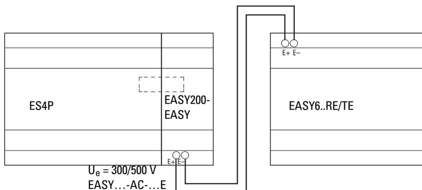
Abbildung 31: Dezentrale Standard-Erweiterungen an easySafety ES4P anschließen
