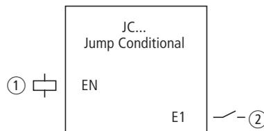
Abbildung 120: Funktionsbaustein „Bedingter Sprung“
