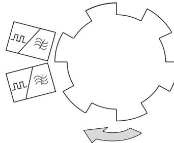
Abbildung 222:Höchstdrehzahlüberwachung: Drehzahlerfassung
