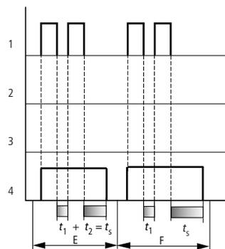
Abbildung 157: Wirkdiagramm Zeitrelais rückfallverzögert (mit/ohne Zufallsschalten, mit/ohne Retriggerung)
