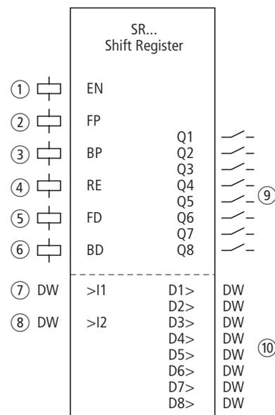
Abbildung 142: Funktionsbaustein „Schieberegister“
