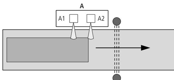
Abbildung 213:Lichtgitter Muting: Sequentielles Muting mit 2 Mutingsensoren
