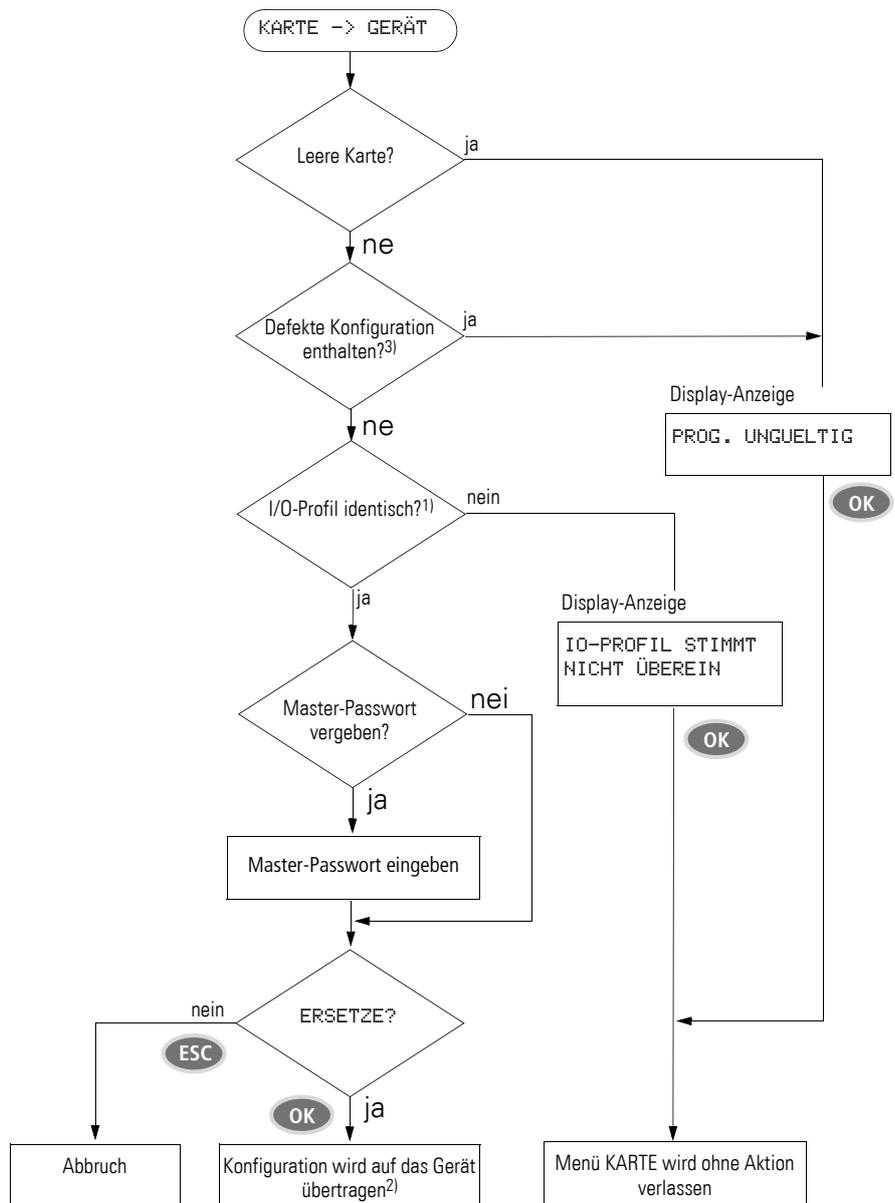
Abbildung 48: Konfiguration von der Karte laden
