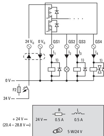
Abbildung 18: Transistor-Ausgänge ES4P-22.-DM..
