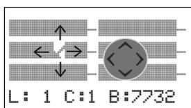
Der Verdrahtungsstift funktioniert zwischen Kontakten und Relais. Wird der Stift auf einen Kontakt oder eine Relaispule bewegt, wechselt er zum Cursor zurück und kann neu eingeschaltet werden.
