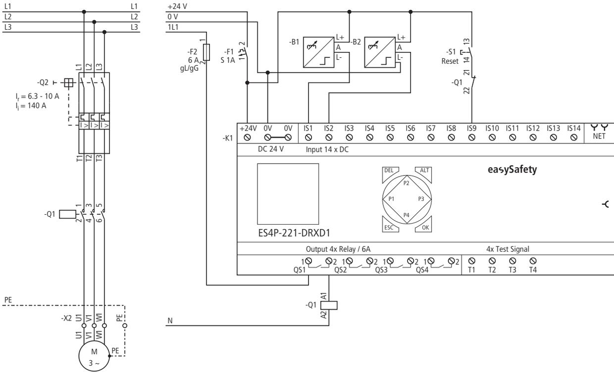
Abbildung 223: Beispiel „Höchstdrehzahlüberwachung“: Elektrischer Schaltplan
