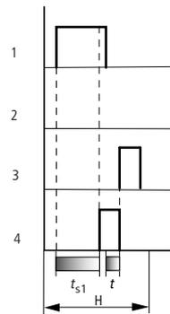
Abbildung 160: Wirkdiagramm Zeitrelais, ansprech- und rückfallverzögert 3
