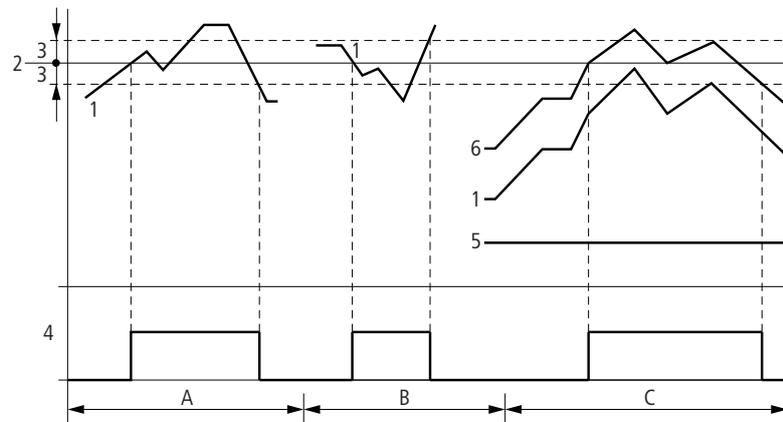
Abbildung 72: Wirkdiagramm „Analogwert-Vergleicher“
