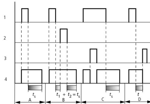
Abbildung 156: Wirkdiagramm Zeitrelais rückfallverzögert (mit/ohne Zufallsschalten, mit/ohne Retriggerung)
