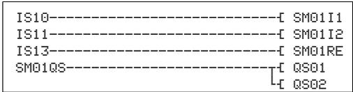
Abbildung 251: Beispiel 1 „Schaltmatte“: Schaltplan in easySafety ES4P
