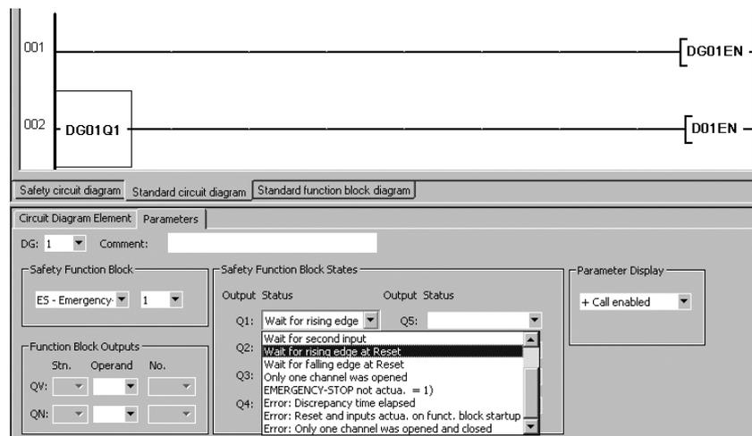
Abbildung 299: Zuordnung von Diagnose- und Sicherheits-Funktionsbaustein mit easySoft-Safety
