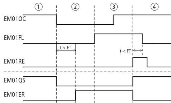
Abbildung 176: Beispiel Rückführung: Zeitdiagramm
