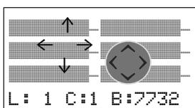
Den Cursor bewegen Sie mit den Cursortasten  $\wedge \vee \langle \rangle$  über das unsichtbare Schaltplanraster. Die ersten vier Spalten sind die Kontaktfelder, die fünfte Spalte bildet das Spulenfeld. Jede Zeile ist ein Strompfad. eaSySafety ES4P legt den ersten Kontakt automatisch an Spannung.
