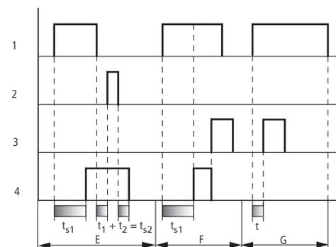
Abbildung 159: Wirkdiagramm Zeitrelais, ansprech- und rückfallverzögert 2
