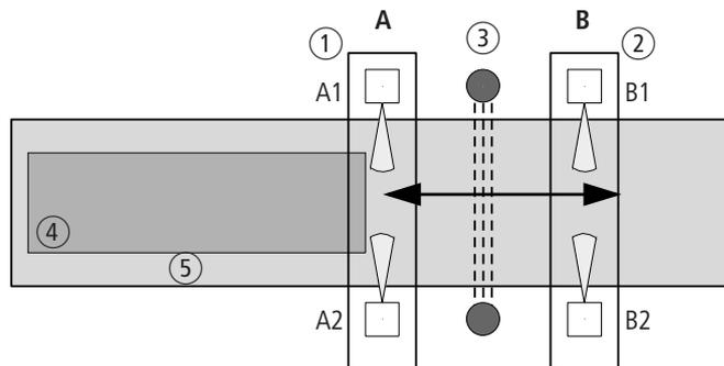
Abbildung 210: Lichtgitter Muting: Beispiel-Abbildung, Pfeilrichtung zeigt die mögliche Bewegungsrichtung des Transportgutes an, die vom Mutingverfahren unterstützt wird.
