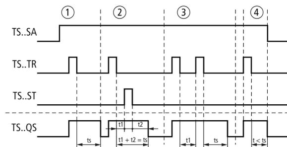
Abbildung 266: Wirkelement „Zeitrelais rückfallverzögert“ (mit/ohne Retriggerung)
