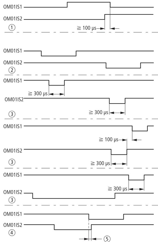
Abbildung 226: Zeitliches Verhalten der Signale an IS1/IS2
