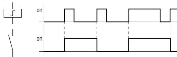
Abbildung 59: Wirkdiagramm „Stromstoßrelais“
