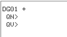
Wenn Sie den DG-Baustein erstmalig im Schaltplan verwenden, gelangen Sie mit OK automatisch in die Gesamtanzeige der Bausteinparameter, wie beispielhaft in der Abbildung links dargestellt. Hier können Sie die Ausgänge QV und QN einstellen. Die Anzeige enthält folgende Elemente:
