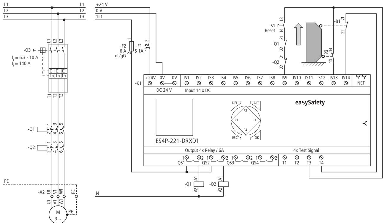
Abbildung 241: Beispiel 1 "Schutztür": Elektrischer Schaltplan
