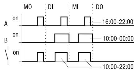
Abbildung 108:Wirkdiagramm Überschneidungen
