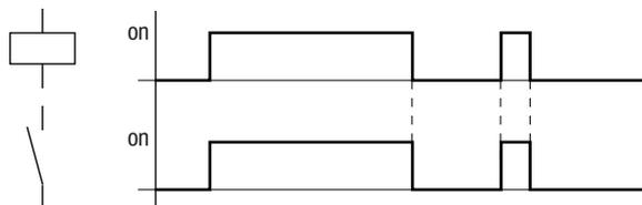
Abbildung 58: Wirkdiagramm „Schützfunktion“
