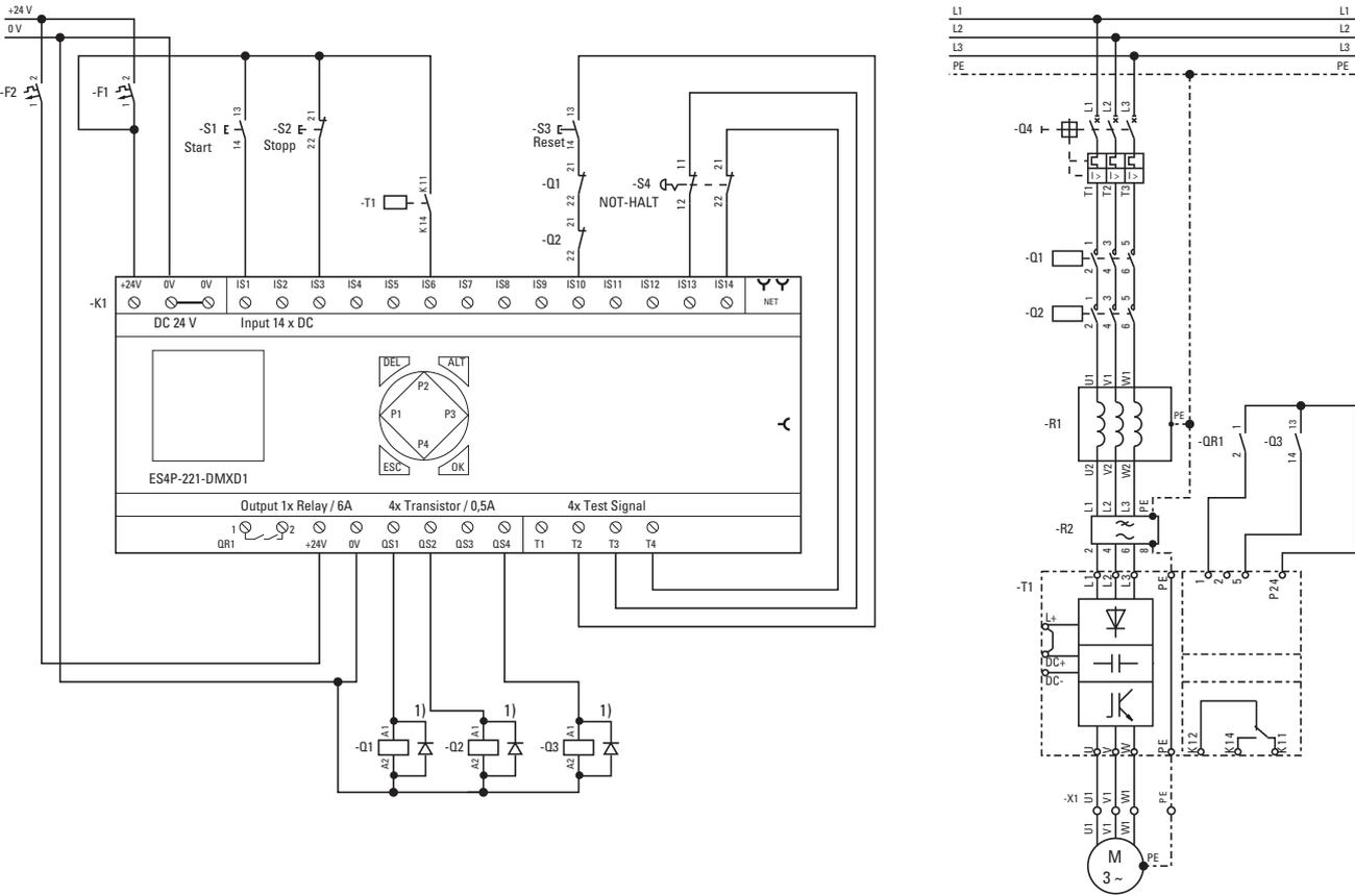
Abbildung 270: Beispiel, NOT-AUS: Elektrischer Schaltplan
