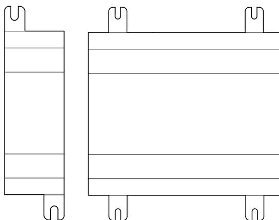
Abbildung 6: Schraubmontage easySafety ES4P
