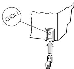
Abbildung 5: Gerätefuß einsetzen
