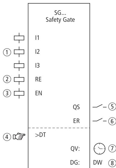
Abbildung 238:Funktionsbaustein „Schutztür“
