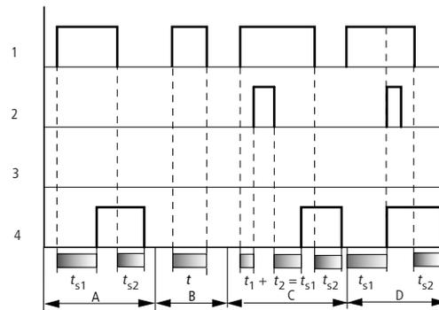
Abbildung 158: Wirkdiagramm Zeitrelais, ansprech- und rückfallverzögert 1
