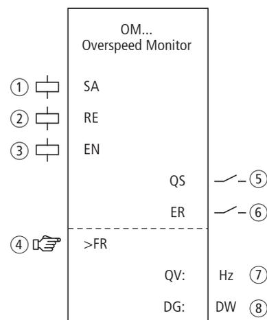
Abbildung 219:Funktionsbaustein „Höchstdrehzahlüberwachung“
