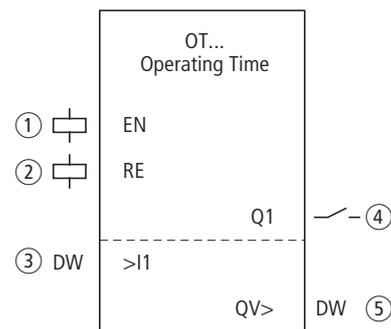
Abbildung 132: Funktionsbaustein „Betriebsstundenzähler“
