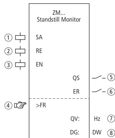
Abbildung 273: Funktionsbaustein „Stillstandsüberwachung“
