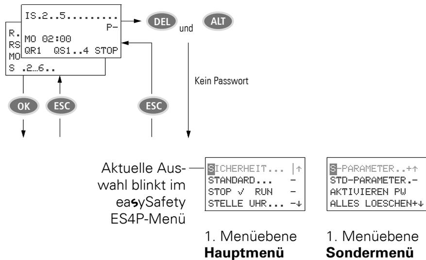
Abbildung 3: Wechsel in das Haupt- oder Sondermenü
