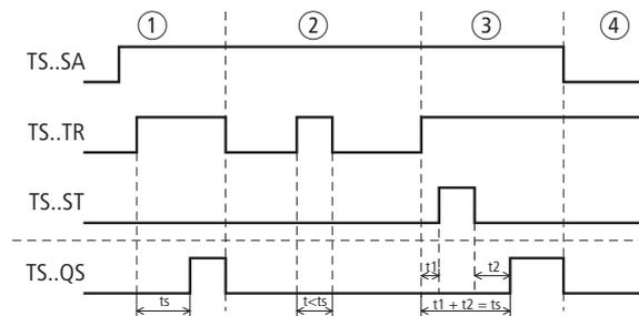
Abbildung 264:Wirkdiagramm „Zeitrelais ansprechverzögert“
