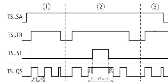
Abbildung 269: Wirkdiagramm „Zeitrelais, blinkend synchron und asynchron“
