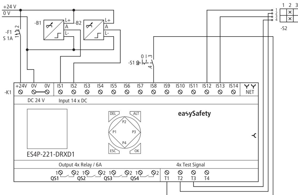
Abbildung 181: Beispiel „Zustimmschalter“: Elektrischer Schaltplan
