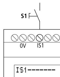
Abbildung 295: easySafety ES4P-Eingang mit Schalter belegt
