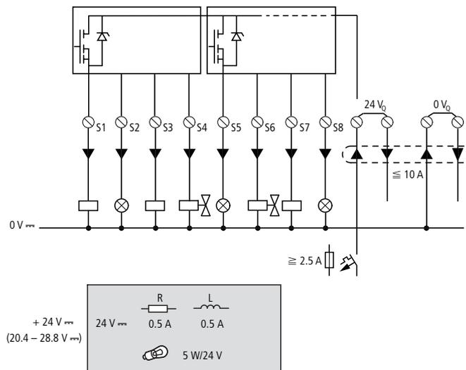
Abbildung 19: Transistor-Ausgänge EASY6..-DC-TE
