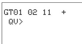
Wenn Sie den Baustein erstmalig im Schaltplan verwenden, gelangen Sie mit OK automatisch in die Gesamtanzeige der Bausteinparameter, wie beispielhaft in der Abbildung links dargestellt. Hier nehmen Sie die Bausteineinstellungen vor. Die Anzeige enthält folgende Elemente:
