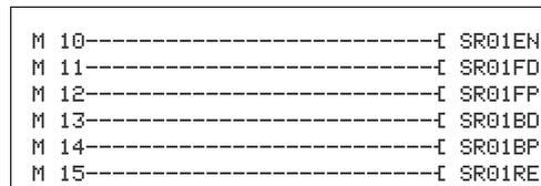
Abbildung 143: Betriebsart BIT, Verdrahtung der Bausteinspulen
