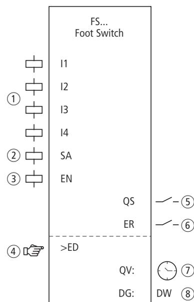
Abbildung 190:Funktionsbaustein „Sicherheits-Fußschalter“
