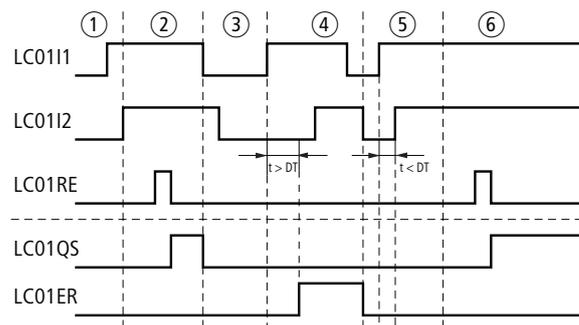
Abbildung 206:Beispiel 2 „Lichtgitter“: Zeitdiagramm
