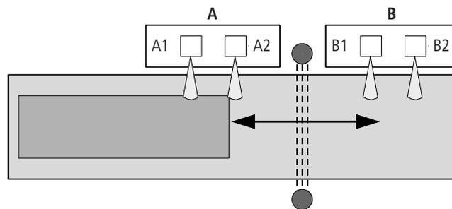
Abbildung 214: Lichtgitter Muting: Sequentielles Muting mit 4 Mutingsensoren
