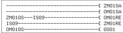
Figure 225 : Exemple « Surveillance de la vitesse maximale » : schéma en easySafety
