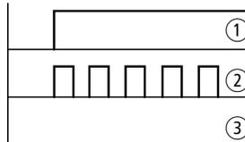
Abbildung 7: Anzeigefunktion POW-LED
