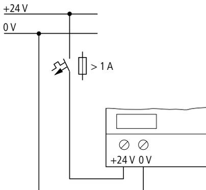
Abbildung 5: Standardanschluss
