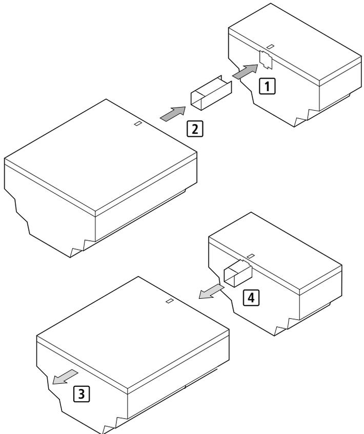
Abbildung 3: EASY204-DP an Grundgerät montieren [1] + [2],
