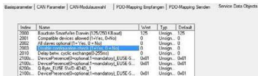
Abbildung 19: „Disable Configuration check“ auf „1“ setzen in XSoft-CoDeSys-2
