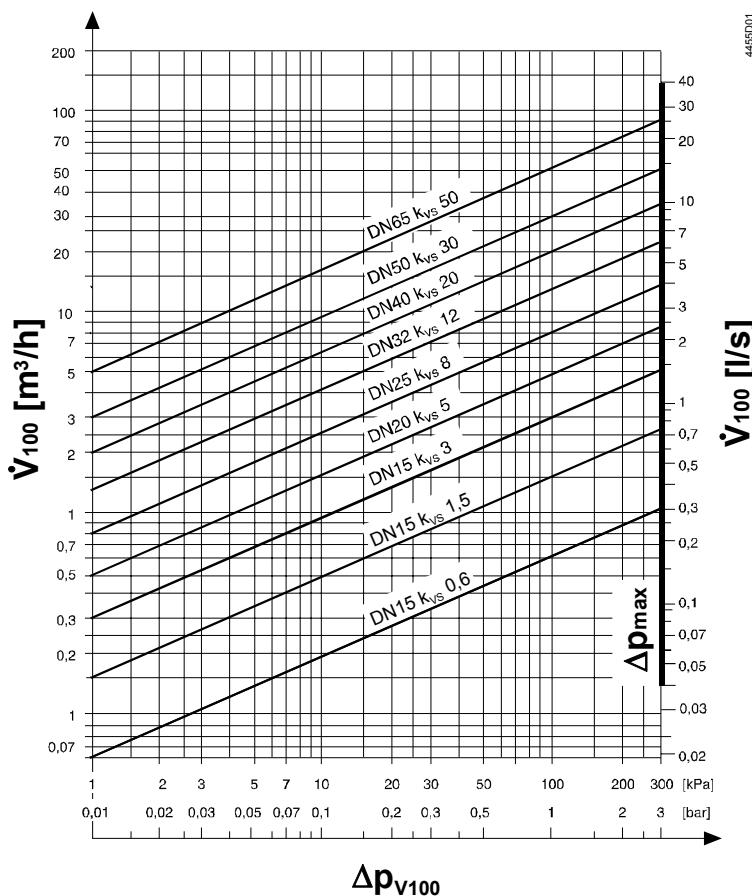
$\Delta p_{V100}$  = перепад давления в полностью открытом клапане при объемном расходе  $\dot{V}_{100}$
