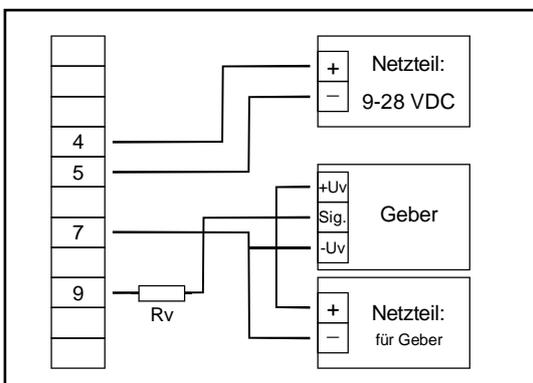
Anschluss eines Gebers (mit getr. Versorgung) mit TTL- oder PNP-Ausgang und Vorwiderstandes zur Strombegrenzung
