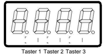
Damit ist die Einstellung von Offset- und Steigungskorrektur des Gerätes abgeschlossen. Drücken Sie die Taste 3 um zur Anzeige des Messwertes umzuschalten.
