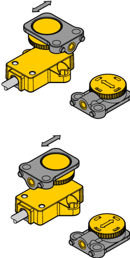
Позиционирующий элемент можно установить под углом 90°. Это обеспечивает гибкость при монтаже. Благодаря принципу измерения, который основан на коммутации колебательного контура, датчик имеет иммунитет к намагниченным металлическим частям и другим помехам.
