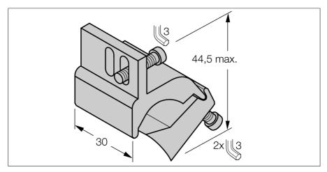
комплектующие для магнитоиндуктивных датчиков и для их монтажа на цилиндр со стяжной шпилькой, диаметр цилиндра 50...125 мм, алюминий
