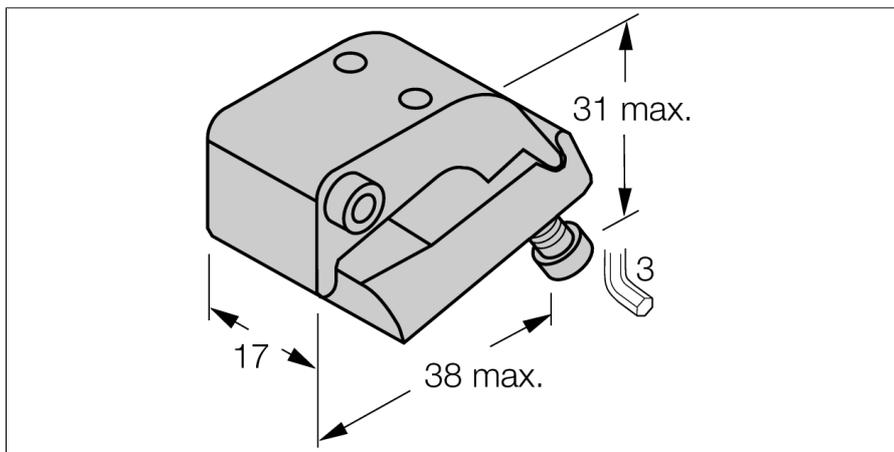
приспособления монтажа для магнитно-индуктивных датчиков с креплением на круглом цилиндре диаметром 50...63 мм, нержавеющая сталь
