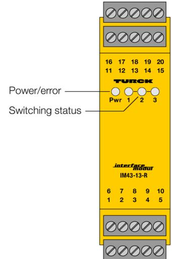
Модуль контроля предельного значения IM43-13-R - это одноканальное устройство, контролирующее недостаточное значение/превышение заданных значений тока 0/4...20 мА или напряжения 0/2...10 В.
