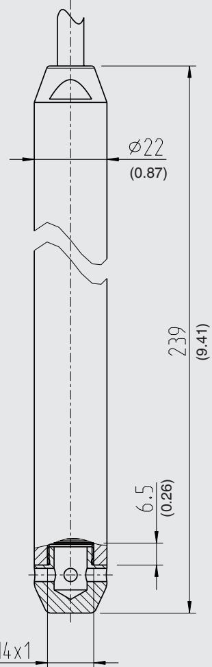
С отверстием для промывки датчика
