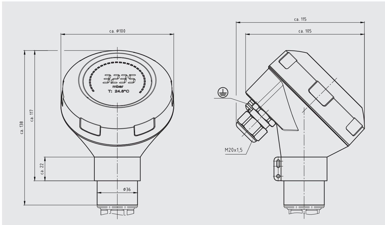
**Преобразователь давления в корпусе из нержавеющей стали, модели UPT-20 и UPT-21**
