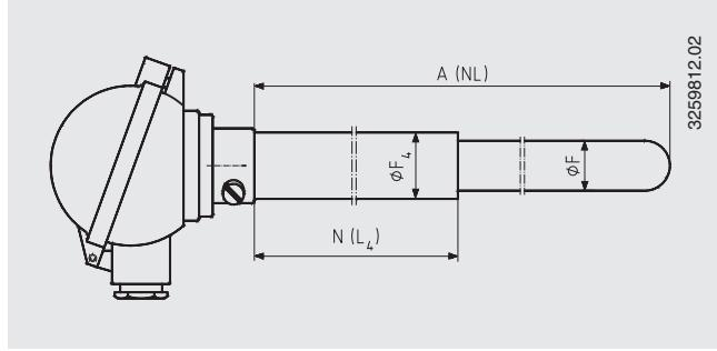
Размеры для исполнения с диаметром гильзы  $< 24$  мм
