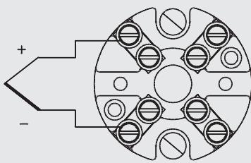
Клеммы термопары обозначаются цветом в соответствии со стандартами (таблица ниже).
