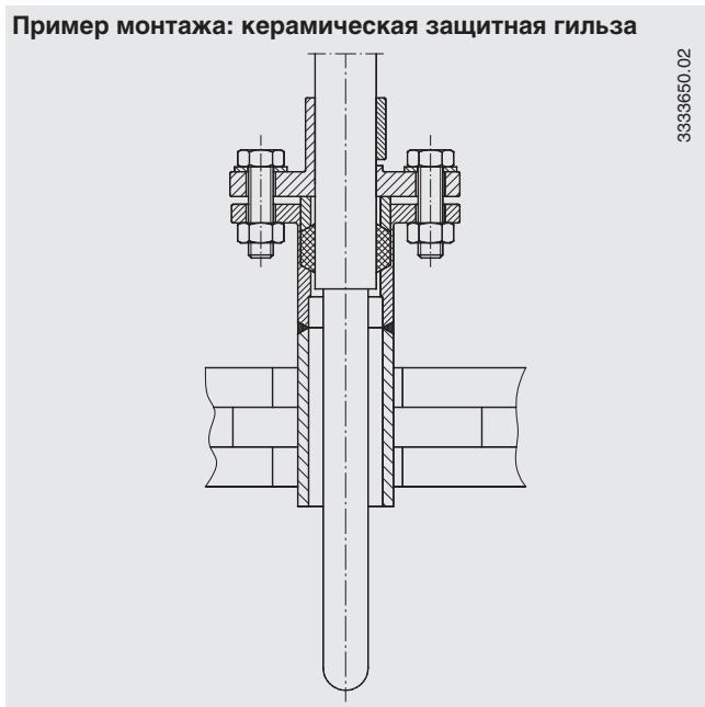
Дополнительно к этим мерам должны приниматься меры к защите гильз от механических воздействий. Основные негативные воздействия оказывают силы, действующие в горизонтальном направлении, и вызывающие изгибающие напряжения на корпусе гильзы. Поэтому, в зависимости от диаметра, nominalной длины и исполнения гильзы, может появиться необходимость в дополнительном укреплении общей конструкции в месте установки.
