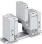
ITV0000 Компактный электро-пневматический преобразователь | ∅4<br>∅6                                | до 3.5 (вх. давл 0.2МПа)<br>до 6.0 (вх. давл 0.6МПа)<br>до 2.0 (вх. давл -0.101МПа) | 0.001 ~ 0.1<br>0.001 ~ 0.5<br>0.001 ~ 0.9<br>-1 ~ -100 кПа                                             | Входы:<br>0 ~ 5; 0 ~ 10 В;<br>4 ~ 20; 0 ~ 20 мА<br>Выход - аналоговый (1 ~ 5 В)                                                                 | 177       |
