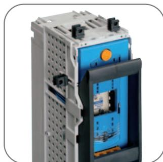
Универсальный зажим для крышек рамы можно использовать на различных установочных глубинах (от 120 до 150 мм) и во всех стандартных шкафах. Зажим можно передвигать с шагом в 5 мм.
