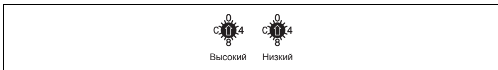
Рис. 55: BC7321-1 – цифровые переключатели для установки номеров узлов и скорости передачи
