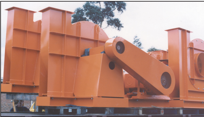
MVW 360 Fans, Arr. 1, 75kw
