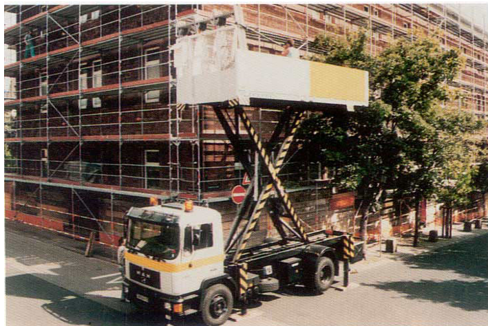
Podnośnik nożycowy z automatycznym poziomowaniem podpór.
