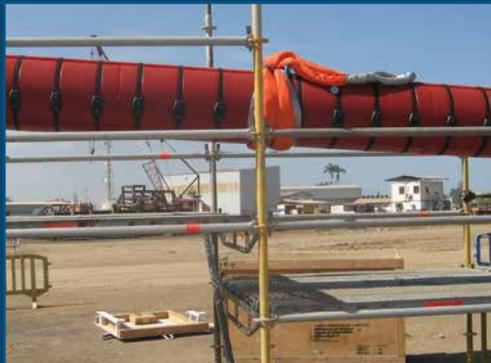
Die Installation von Unterseekabeln ist ein weites Feld mit dem Kabelschutz als wichtigem Element. HCL arbeitet mit Herstellern von Halbschalenkabelschützern zusammen um eine komplette Lösung in diesem Bereich anbieten zu können.
