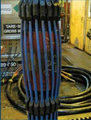
Der Smart<sup>®</sup> Protector ist ein Polymer-Kabelschützer zur Verwendung bei Tiefseebohrungen und immer dann, wenn Kabel und Schläuche an Förderrohren oder -Leitungen befestigt werden müssen.
