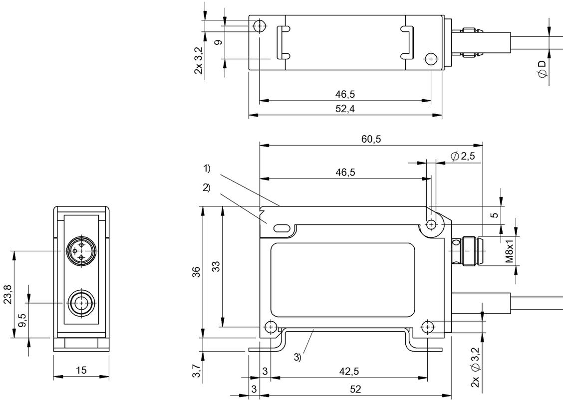
1) Панель индикации и управления 2) Крышка 3) Защитная шина
