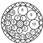
Провод 1: красный/синий Провод 10: синий 1,0 мм<sup>2</sup> Провод 11: белый Провод 12: зеленый Провод 13: желтый Провод 14: серый Провод 15: розовый Провод 16: красный Провод 17: черный Провод 18: фиолетовый Провод 19: серый/розовый Провод 2: белый/зеленый Провод 3: коричневый/зеленый Провод 4: белый/желтый Провод 5: желтый/коричневый Провод 6: белый/серый Провод 7: серый/коричневый Провод 8: зеленый/желтый 1,0 мм<sup>2</sup> Провод 9: коричневый 1,0 мм<sup>2</sup>
