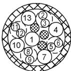
Провод 1: зеленый/желтый 1,0 мм<sup>2</sup> Провод 10: синий (1) 1,0 мм<sup>2</sup> Провод 11: белый/зеленый Провод 12: коричневый/зеленый Провод 13: синий (2) 1,0 мм<sup>2</sup> Провод 2: белый Провод 3: зеленый Провод 4: коричневый (1) 1,0 мм<sup>2</sup> Провод 5: желтый Провод 6: серый Провод 7: коричневый (2) 1,0 мм<sup>2</sup> Провод 8: серый/розовый Провод 9: красный/синий
