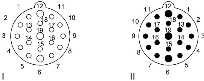
Конт. 12: 1,0 мм<sup>2</sup> Конт.19: 1,0 мм<sup>2</sup> Конт. 6: 1,0 мм<sup>2</sup>    Конт. 12: 1,0 мм<sup>2</sup> Конт.19: 1,0 мм<sup>2</sup> Конт. 6: 1,0 мм<sup>2</sup>
