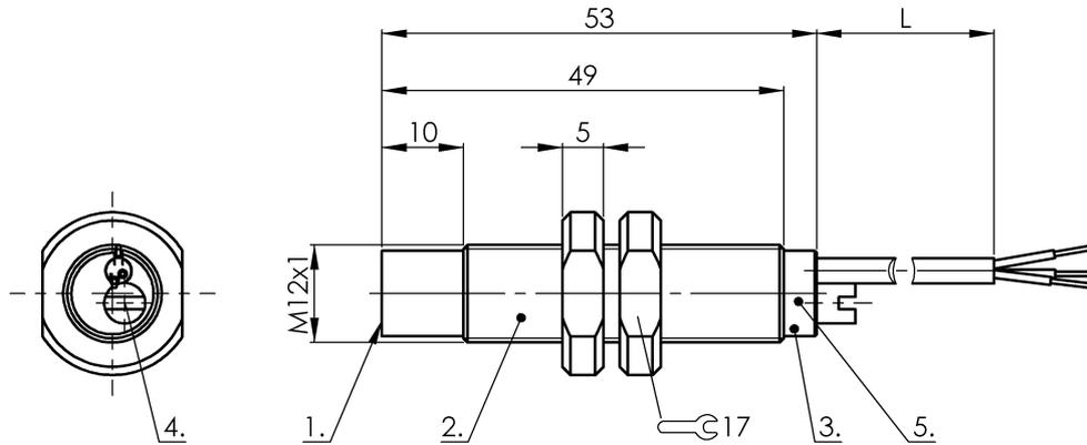
1) Активная поверхность 2) Корпус 3) Крышка 4) Потенциометр 5) Функциональный СИД
