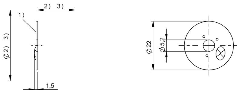
1) Активная поверхность 2) Свободная зона 3) см. соответственно головку записи/считывания 4) Момент затяжки
