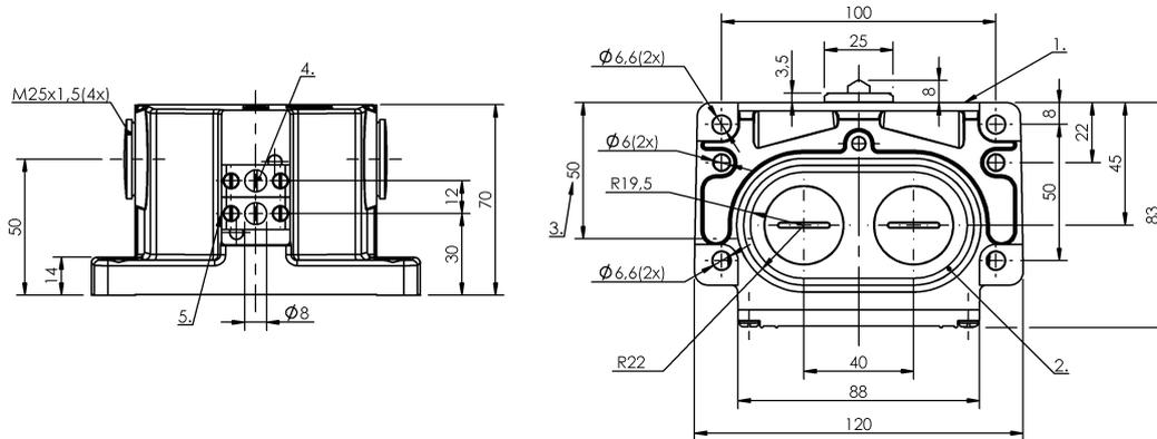
1) Опорная кромка 2) Уплотнительное кольцо 3) Кабельный ввод 4) Противокристаллизационный толкатель 5) Марк. Предохран. точка коммутации
