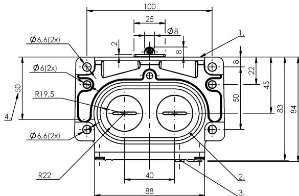
1) Опорная кромка 2) Уплотнительное кольцо 3) Функциональный индикатор FC 4) Кабельный ввод 5) Марк. Предохр. точка коммутации
