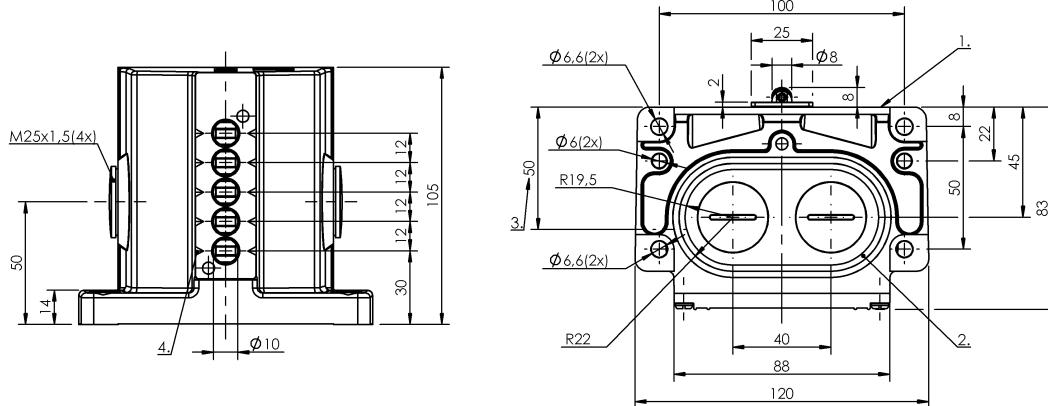
1) Опорная кромка 2) Уплотнительное кольцо 3) Кабельный ввод 4) Марк. Предохр. точка коммутации
