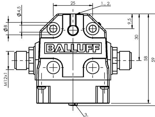
1) Опорная кромка 2) Активная поверхность 3) Функциональный индикатор FD/FE/LL 4) 1-я точка коммутации
